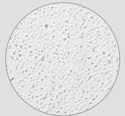
Das Besondere bei Ytong Porenbeton: Luft – in Millionen von Poren im Stein eingeschlossen – dient als perfekter Isolator.
